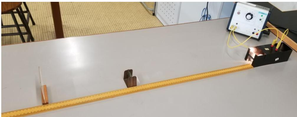
2. 調整半透明屏幕的位置，直到形成一清晰的像，然後量度透鏡和屏幕之間的距離（即像距  $v$ ）。
